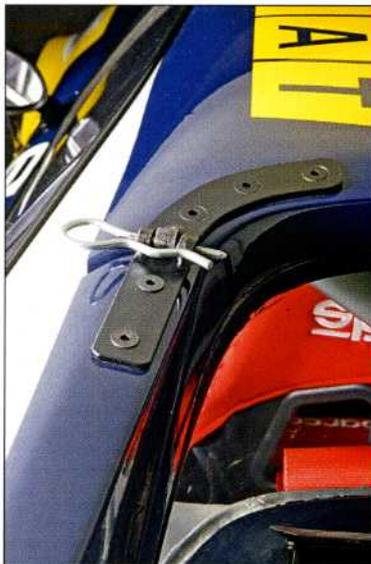
Im Bug Wasserkühler und Heizung (oben). Schnellsplint am Haubenscharnier für rasche Komplettmontage
