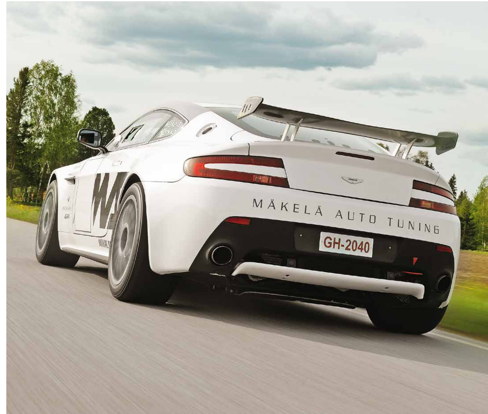
Der Heckflügel generiert wirklichen Abtrieb, wichtig für den Hecktriebler
