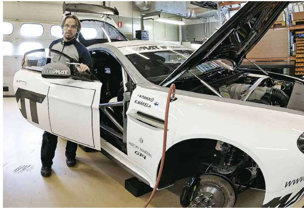
Leichte Kunststofftüren und einen Käfig hat schon der GT4-Vantage serienmäßig
